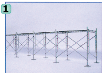
1 1層目のわく組足場を組み立てます。(1層目のみ両面に交さ筋かいを取付けます。)
