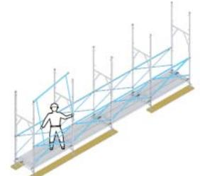
③メガネ手摺のプレス部分を持ち、新型メガネ手摺を片側ずつ大和式連結ピンに取り付ける。
