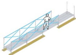
①ベース枠に踏板を設置し、新型メガネ手摺を取り付ける。
