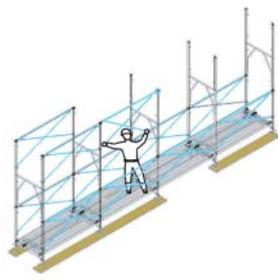
④新型メガネ手摺のプレス部分をグラビティロックに取り付ける。
